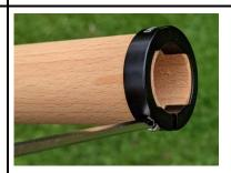
Die Holzgriffe über den Lenker schieben, bis der Klemmring bündig mit dem Lenkerende abschließt.
